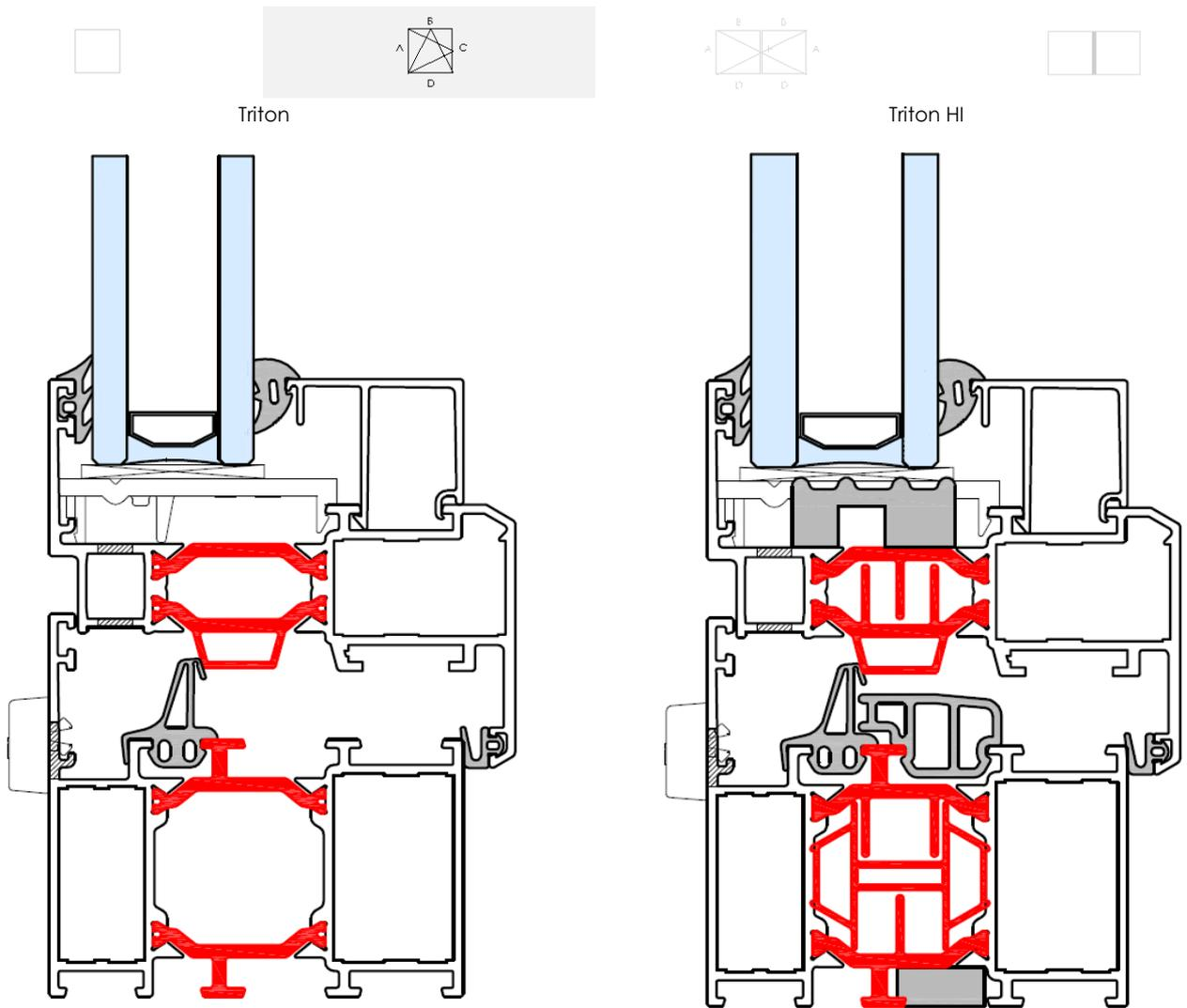
Fig. 5: Coupe-type de fenêtre à double ouvrant
