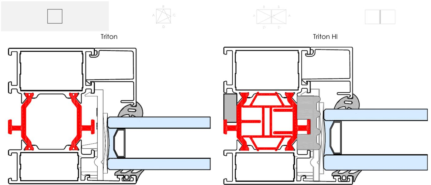
Fig. 4: Coupe-type de fenêtre oscillo-battante
