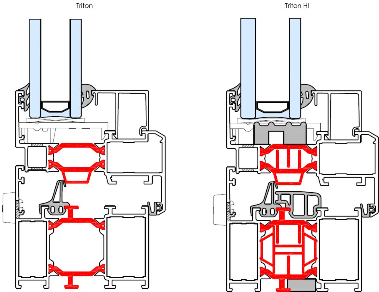
Fig. 3: Coupe-type de fenêtre fixe
