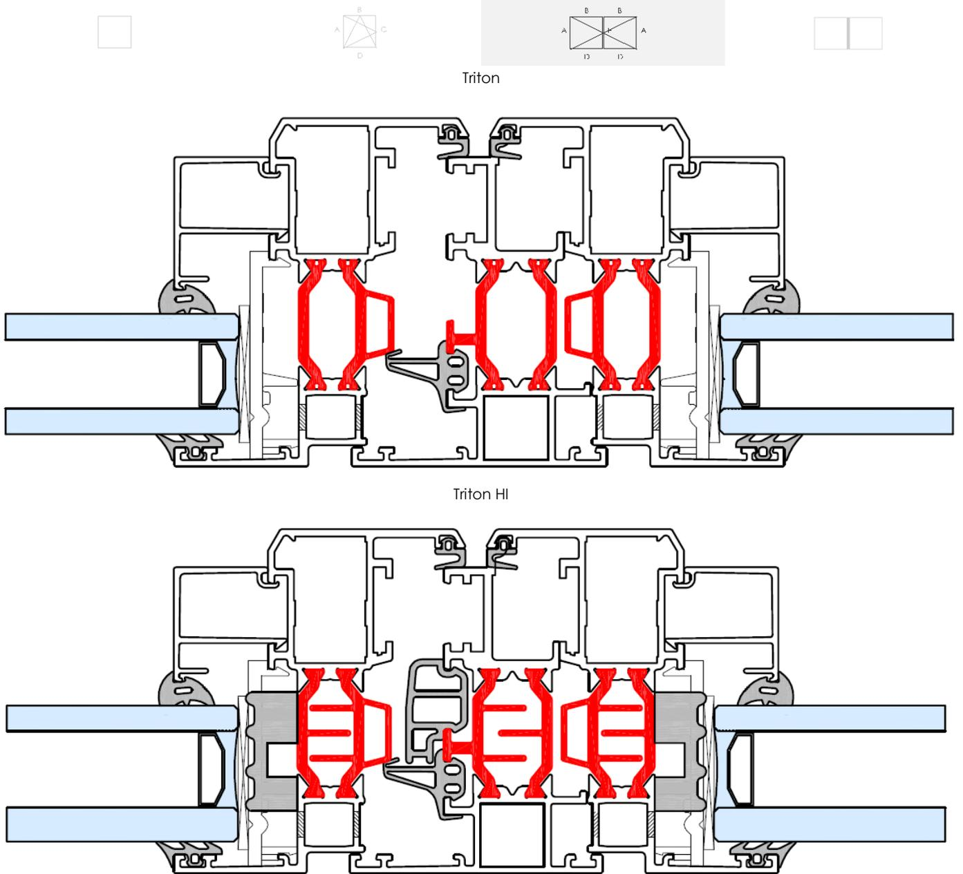
Fig. 6: Coupe-type de fenêtre composée
