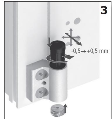
Montez l'axe et la douille du vantail
