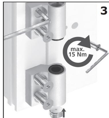
Montez l'axe et la douille du vantail
