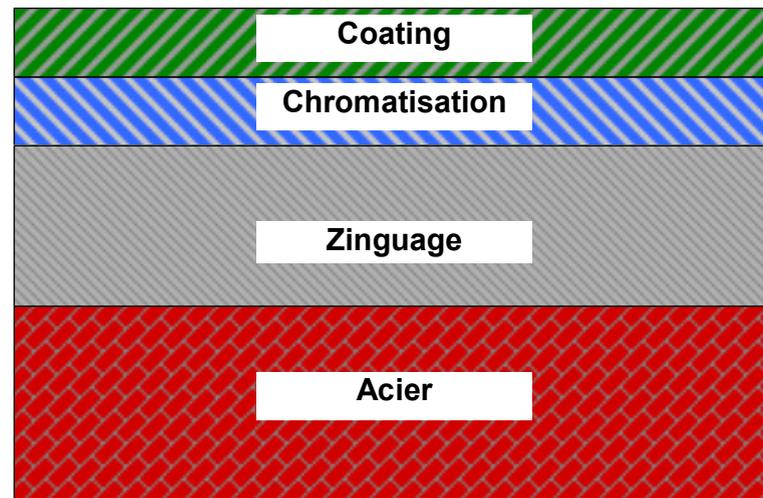
La norme RAL-RG607-3 spécifie qu'aucune corrosion blanche (oxyde de zinc) ne peut apparaître avant 72 h et aucune trace de rouille avant 240 h. Les surfaces de SI-AU résistent le double de ces durées.
