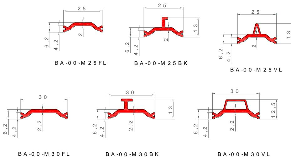
**Figure 5 : Coupures thermiques – systèmes d'assemblage Triton et b-Quick (Ventá) (barrettes ABS)**
