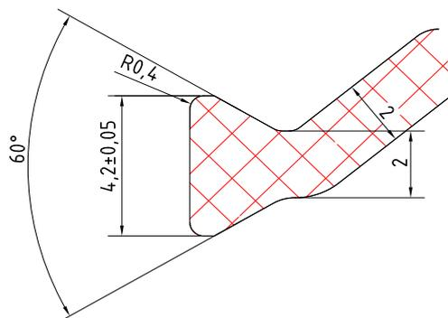
Figure 4 : Coupures thermiques – système d'assemblage Triton (barrettes PA)
