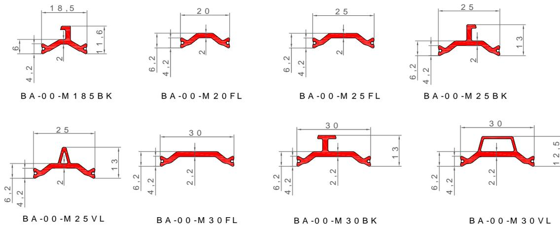
Figure 5 : Coupures thermiques – systèmes d'assemblage Triton, Olympia et b-Quick (barrettes ABS)
