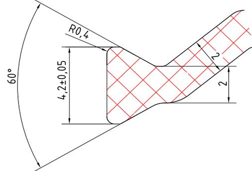
Figure 4 : Coupures thermiques – système d'assemblage Apollo, Hercules et Triton (barrettes PA)
