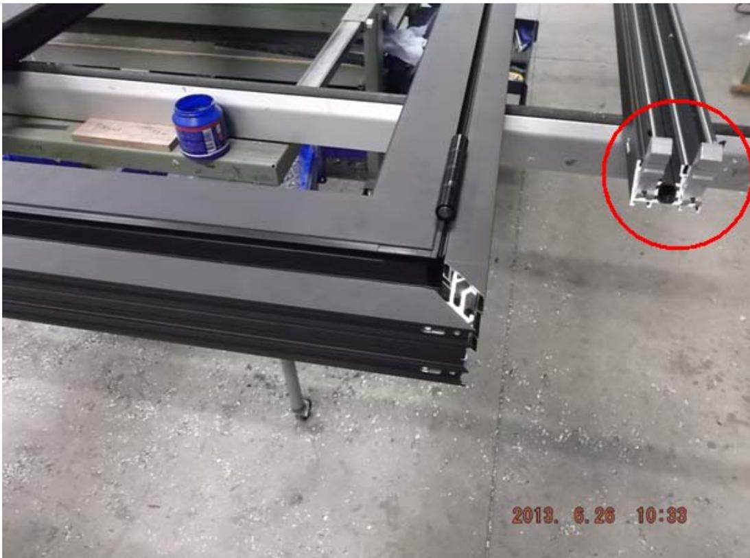
4. Emboiter les pièces du bas et les pièces du haut dans les montants (attention au positionnement des chariots)
