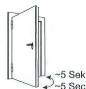
Une porte facile à actionner doit être entièrement fermée par le ferme-porte !
